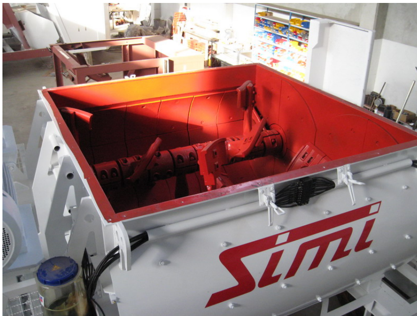
Mixer robust echipat cu elemente de uzura de mare rezistenta
