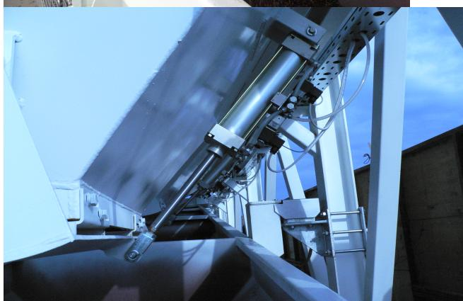
**Dozarea de finete** se regleaza la randul ei prin deplasarea senzorului magnetic pe tija cilindrului pneumatic .
